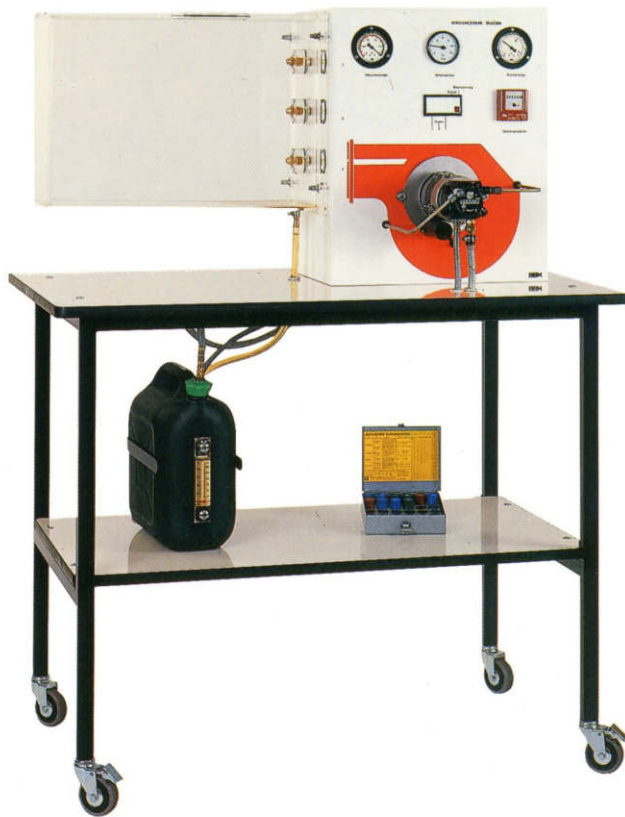
Abbildung zeigt den Schulungsstand für Öldüsen Bestellnummer 0000 9620
