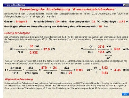
Bewertung der Brenneinstellung, d.h. Überprüfung der Abgaswerte bzw. Abgasverlust
