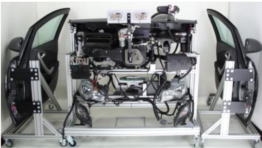
Abbildung zeigt die Armaturentafel CAN- / LIN-Bus mit Originalarmaturentafel, Fahrer- und Beifahrerairbag, die komplette Beleuchtungsanlage und die Instrumentenbeleuchtung eines Astra J.
