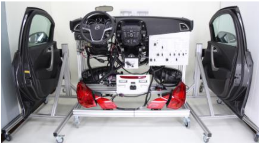
Abbildung zeigt die Armaturentafel CAN- / LIN-Bus mit Originalarmaturentafel, Fahrer- und Beifahrerairbag, die komplette Beleuchtungsanlage und die Instrumentenbeleuchtung eines Astra J.
