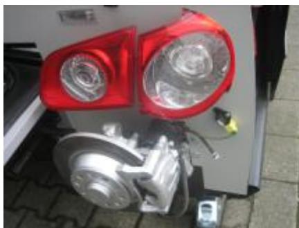
Die Abbildung zeigt die funktionsfähige elektrische Feststellbremse.
