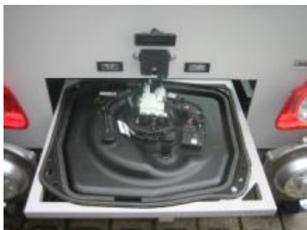
Die Abbildung zeigt den beheizten Zusatztank (17 l) für die Harnstofflösung (AdBlue), der beim Fahrzeug in der Reserveradmulde untergebracht ist.
