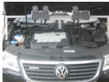
Die Abbildung zeigt den Motorraum mit angebrachten Schnittstellen und Messboxen zum werkstattgerechten Messen.
