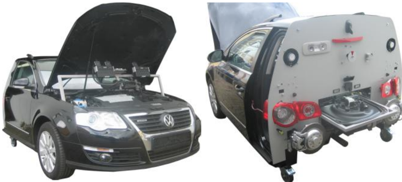
Abbildung zeigt Fahrzeug Funktionsmodell VW Passat Blue TDI Bestellnummer 0000 9358 mit zusätzlich angebrachter Fehlerschaltung für das Motormanagement und das CAN-BUS-System, sowie integrierten Buchsenkästen.
